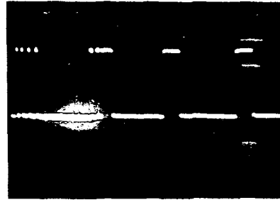
Obr. 7. Průběh napětí na vývodu 6 IO3. Měřítka: y = 1 \text{ V/cm} , x_1 = 5 \text{ ms/cm} , x_2 = 0,5 \text{ ms/cm}
